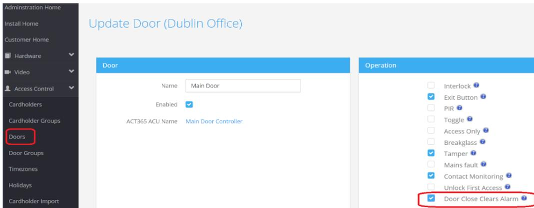
3. Empêcher le bouton Rex d'alimenter le relais de la porte. Depuis le compte installateur, sélectionner le menu « Access Control | Doors » (Contrôle d'accès | Portes), puis désactiver l'option « Exit Button » (Bouton de sortie) sur la porte souhaitée.
